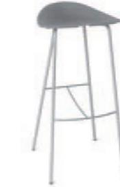
El **armazón** está formado con tubo de acero redondo de 16 mm de diámetro acabado en Cromo Brillo o Epoxi Color. El **asiento** es en Polipropileno texturizado mate. El taburete ANT se presenta en tres **alturas**: 47, 68 y 79 cm.
