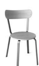
El **armazón** está formado con tubo de acero rectangular de 10x30 mm acabado en Epoxi Color. El **asiento** es de madera de Haya de 15mm y el **respaldo** de madera de Haya de 10 mm, barnizadas o lacadas.
