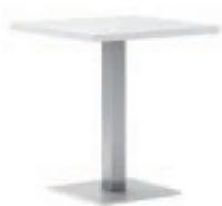
La **base** es cuadrada de 45x45 cm de acero de 10 mm de espesor acabado en Cromo Granallado. La **columna** es de acero, con perfil cuadrado de 80x80 mm, acabado en Epoxi Color o Cromo Brillo. La **encimera** puede ser en Compacmel de 13 mm con canto recto o biselado, Estratificado o madera de Haya de 20 o 30 o 60mm (canto regresado) o en Cristal securit Transparente, Extra Blanco o Color de 8mm. La mesa CAFÉ se presenta en **altura** 75, 90 y 110 cm.
