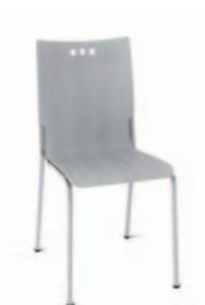
El **armazón** está formado con tubo de acero cuadrado de 16 mm acabado en Cromo Brillo o Epoxi Color. Los apoyabrazos forman parte del armazón. El **asiento** puede ser en madera de Haya de 10 mm barnizada o lacada, o en Tapizado y el **respaldo** es una malla doble de tejido Screen. Dichos apoyabrazos están recubiertos por protectores de polietileno.
