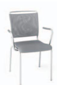
El **armazón** está formado con tubo de acero redondo de 20 mm de diámetro acabado en Cromo Brillo o Epoxi Color. El **asiento** puede ser en madera de Haya de 10 mm barnizada o lacada, o en Tapizado y el **respaldo** es una malla doble de tejido Screen.
